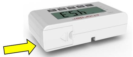
6. Mettre sous tension pour confirmer que la batterie est correctement installée.
