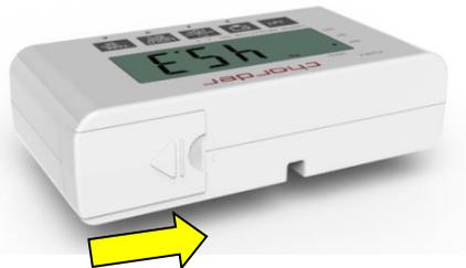
6. Mettez sous tension pour confirmer que la batterie est correctement installée.
